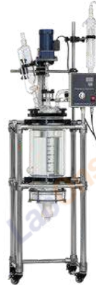
Reactorkamer met dubbele glaswand
