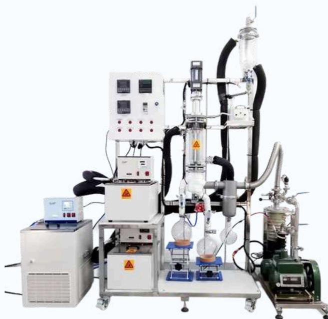
Гибридная молекулярная дистилляция — это специализированный метод дистилляции, сочетающий в себе преимущества стекла и нержавеющей стали. Этот гибридный подход направлен на оптимизацию разделения и очистки веществ с высокими температурами кипения, низкой летучестью или термической чувствительностью, используя при этом уникальные свойства обоих материалов.
